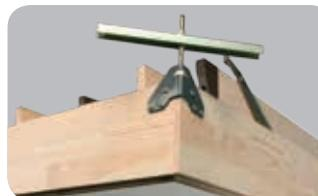
Montážní úhelníky zjednodušují a zefektivňují montáž schodů ve stropě. Montáž ve stropě s max. tloušťkou 43 cm (pro schody LWT, LWF a LMF 45), 39 cm pro schody LTK Energy a 35 cm pro ostatní modely.
