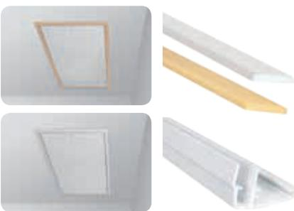
Krycí lišty slouží k zakrytí spár kolem skříně po montáži schodů ve stropě. Jsou vyrobeny z borovicového masivu v přírodním (LXL-P) nebo bílém provedení (LXL-W), anebo z PVC (LXL-PVC). Lišty PVC se spojují se skříní schodů bez použití hřebíků.
