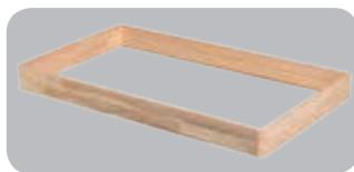
Nástavný rám z borovicového dřeva skvěle ladí se skříní namontovaných půdních schodů a umožňuje esteticky dohotovit stropní otvor. V případě stropů s tloušťkou větší než 31 cm u čtyřdílných skládacích schodů, a u stahovacích schodů LST a LSZ navíc slouží jako díl prodlužující výšku skříně, a umožňuje montáž horního krytu LXW. Standardní výška nástavného rámu je 10 cm; maximální atypická výška nástavného rámu je 16 cm pro schody LDK a 20 cm pro ostatní typy půdních schodů.
