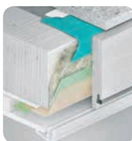
Izolační sada slouží k rychlému utěsnění mezery mezi skříní namontovaných schodů a otvorem ve stropě. Použití sady zaručuje správné provedení tzv. „teplé montáže“, která je klíčová zvláště v nízkenergetických stavbách. Součástí sady je parotěsný límec, termoizolační materiál z ovčí vlny a paropropustný límec.
